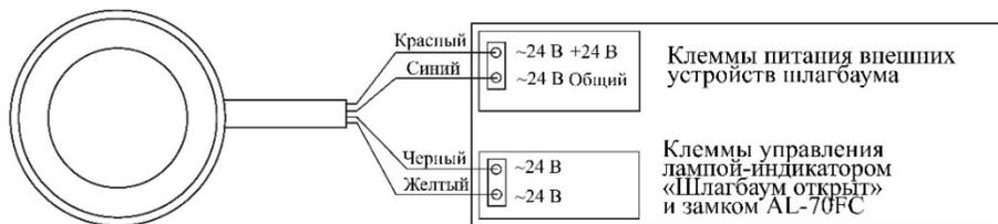
Рисунок 5 - Схема подключения замка
