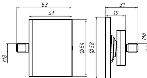
Рисунок 2 – Габариты корпуса и якоря замка AL-70FC
