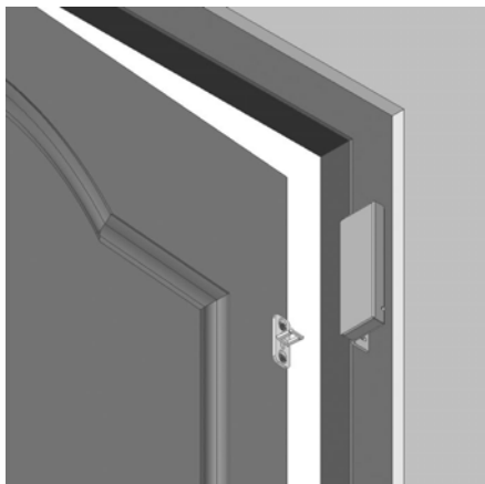
Рис.3 Установка замка на монтажный L- уголок
